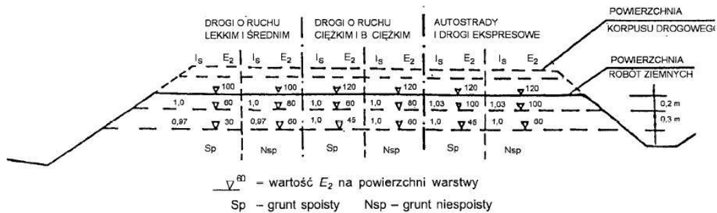
Rysunek 4 – Wartości wymagane w podłożu wykopów: wskaźnika zagęszczenia I_s i wtórnego modułu odkształcenia E_2 , megapaskali
