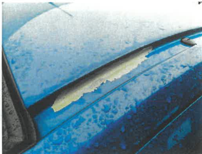
Ryniekna dachowa - oderwana powłoka lakierowa.
