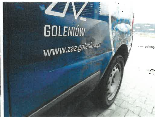
Uszkodzenia boku lewego.
