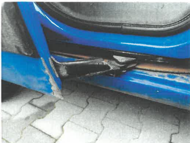
Drzwi przesuwne, wgniecione, skorowowane w cz, dolnej.
