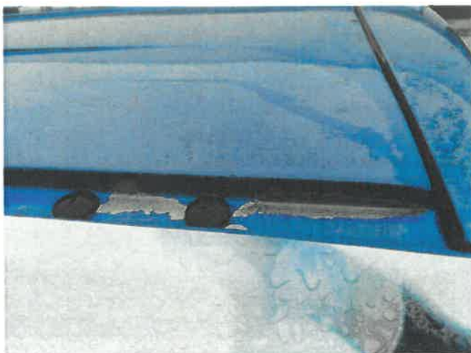
Rynieka dachowa - oderwany lakier.
