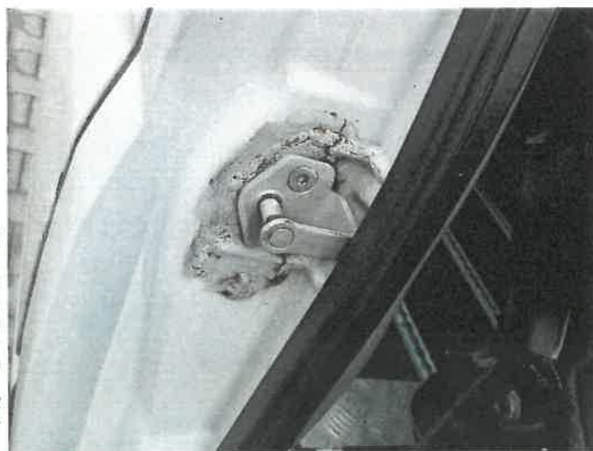
Uszkodz. słupek przy kabłąku zamka drzwi P.P.
