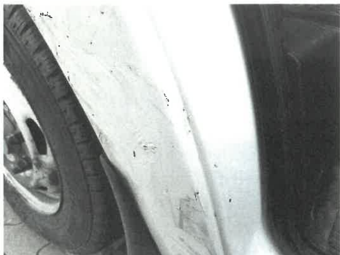
Błotnik P.L. - korozja podpowłokowa.
