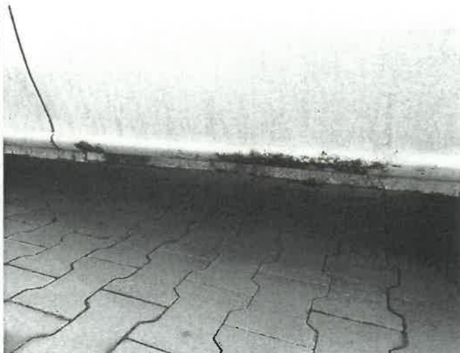
Próg i poszycie prawe, część tylna - korozja.
