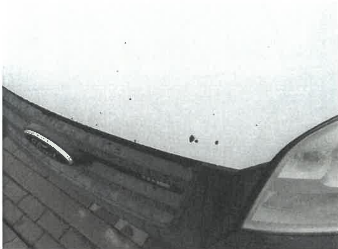
Pokrywa komory silnikowej - odpryski lakieru.
