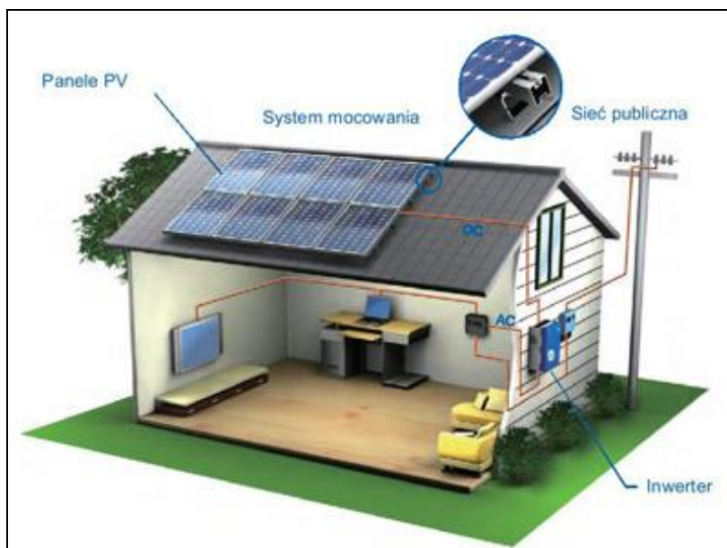
Rysunek 4. Schemat montażu i działania paneli fotowoltaicznych
