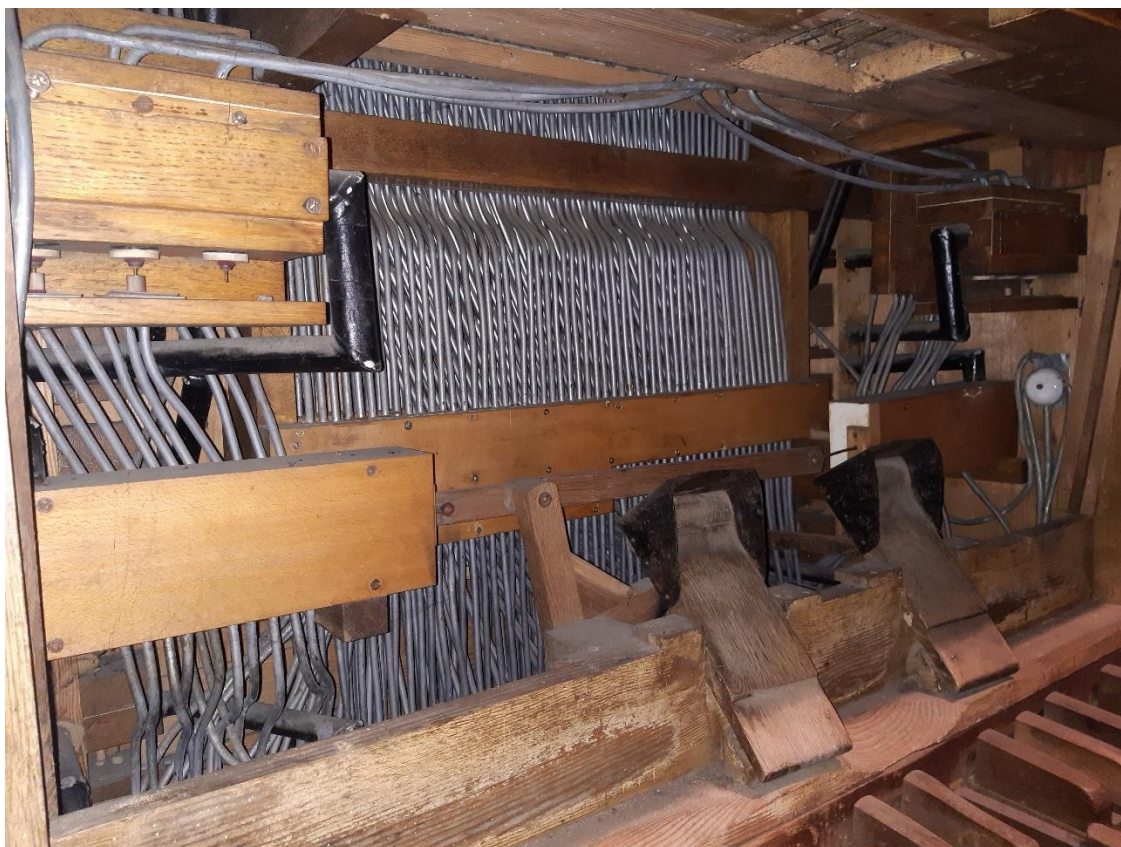
Rysunek 8. Wnętrze kontuaru, widoczne rurki ołowiane, pedały Crescendo oraz żaluzji
