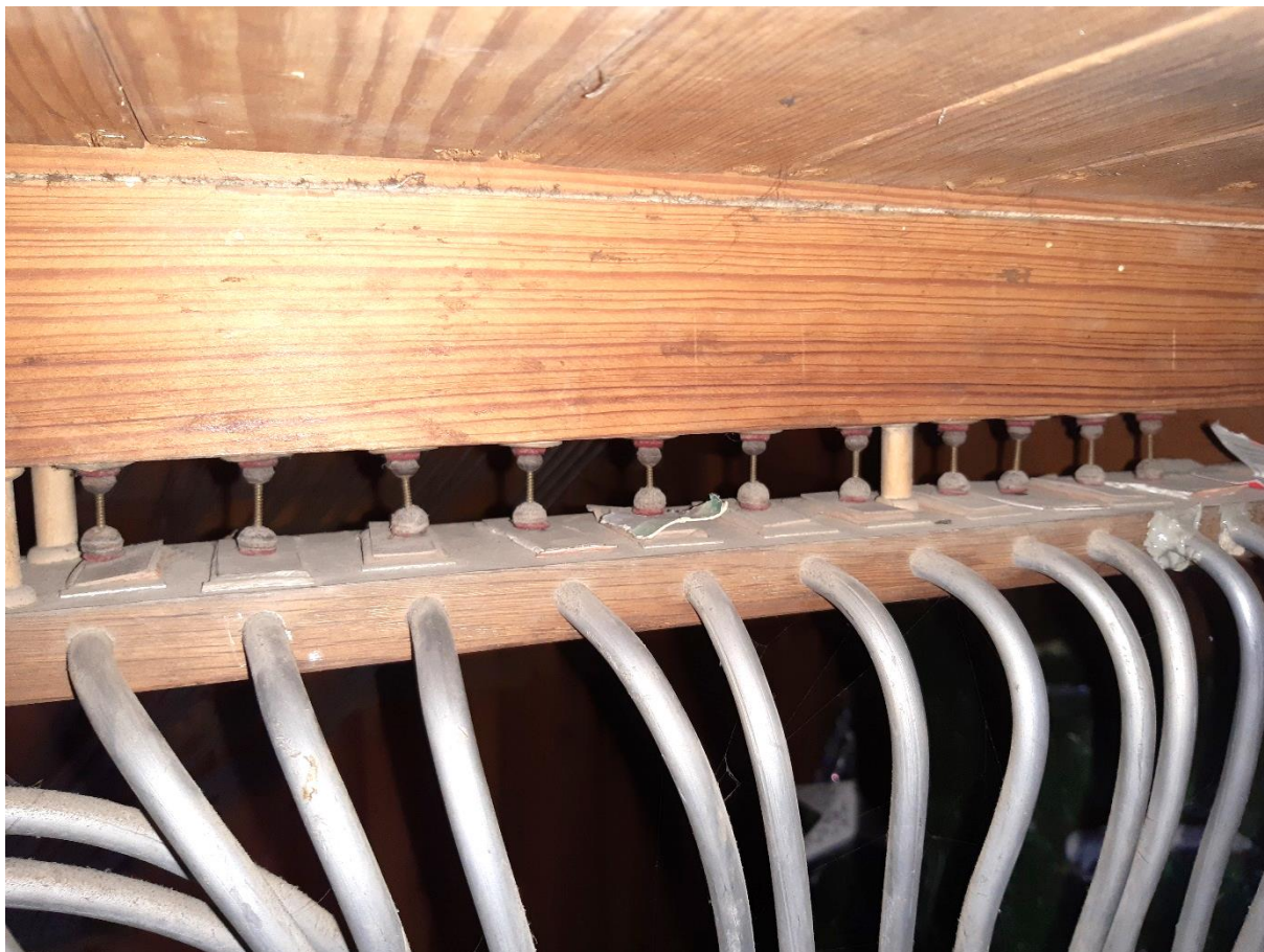
Rysunek 10. Zużyte i uszkodzone mieszki tonowe
