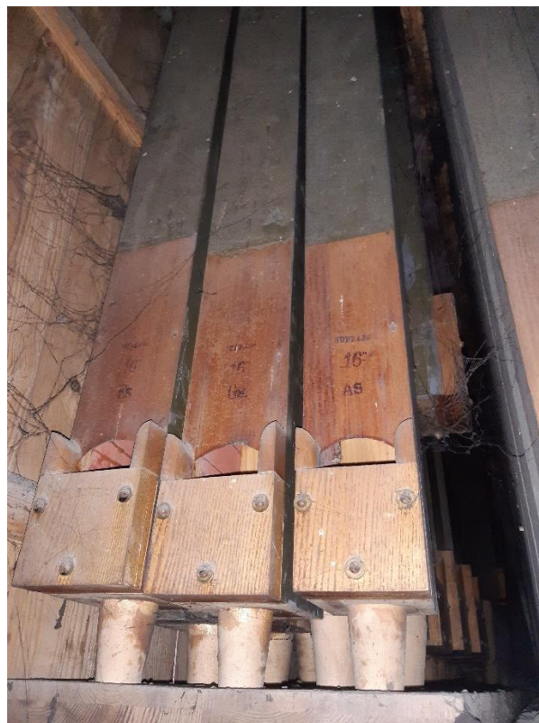
Rysunek 15. Piszczalki Subbasu 16', umieszczone w tylnej części szafy organowej.
