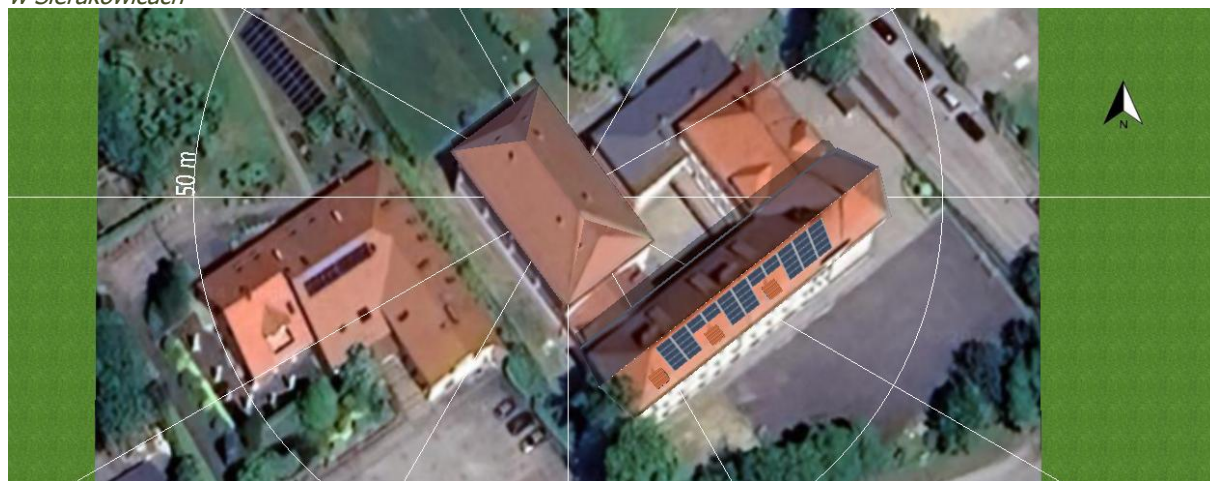
Fotografia 9. Proponowane rozmieszczenie modułów fotowoltaicznych na budynku Zespołu Szkolno-Przedszkolnego w Sierakowicach
