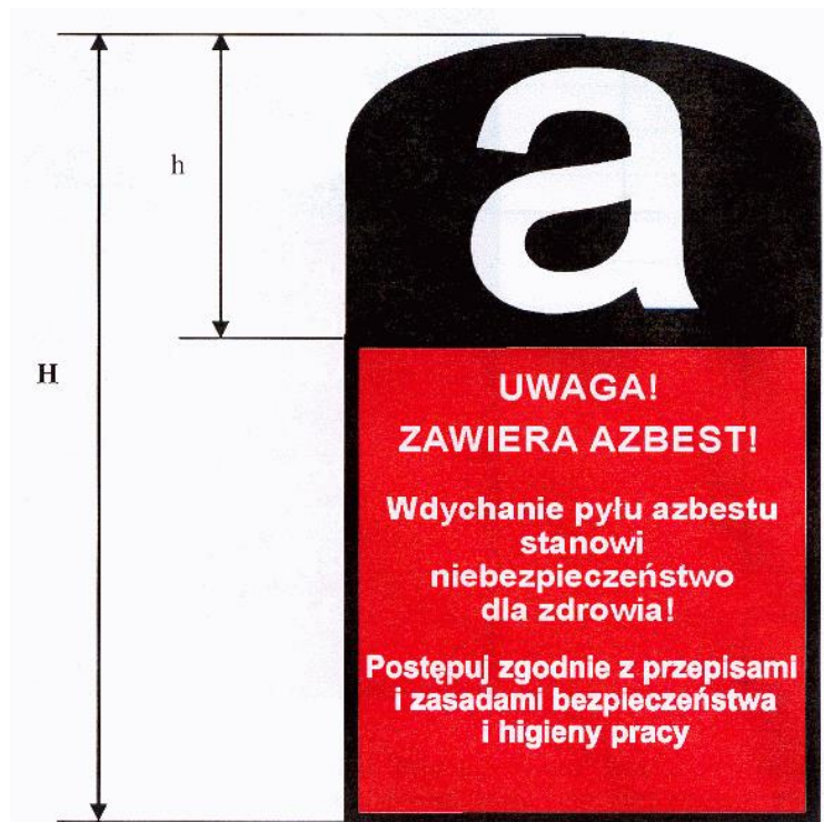
Rysunek 18 Wzór oznakowania instalacji lub urządzeń zawierających azbest oraz rur azbestowo-cementowych
