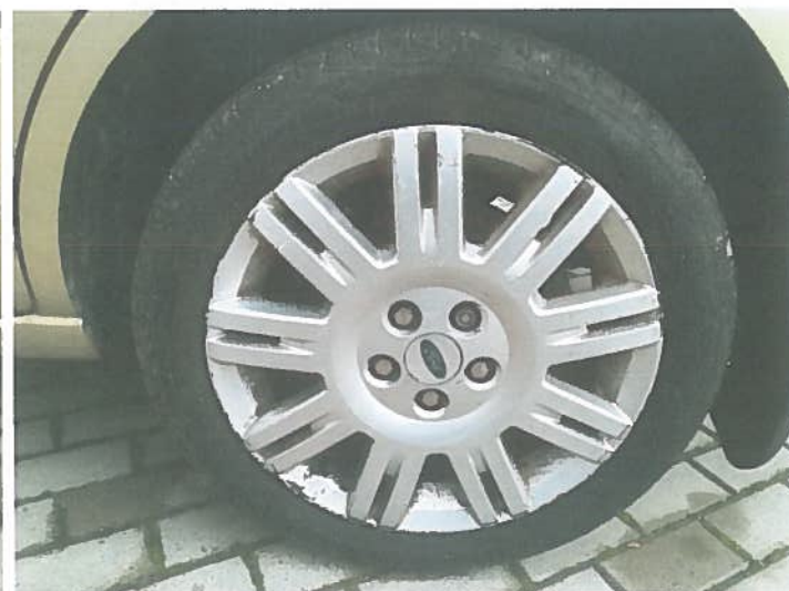
Uszkodzona tarcza koła.
