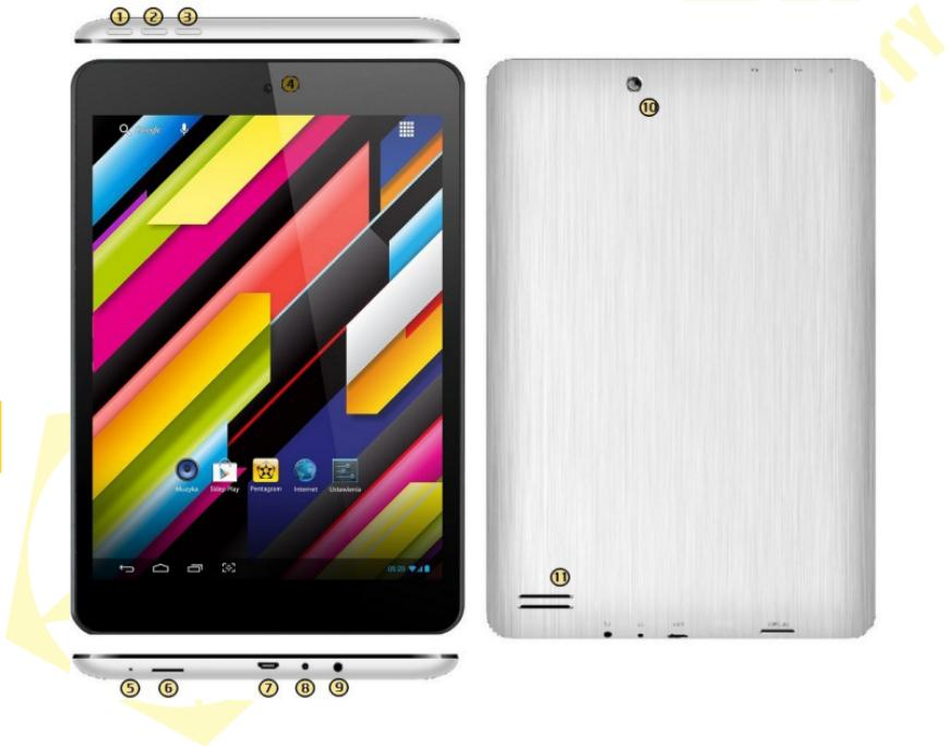
1. Przycisk zasilania - aby włączyć lub wyłączyć urządzenie, przytrzymaj wcisnięty przycisk przez ok. 4 sekundy.
