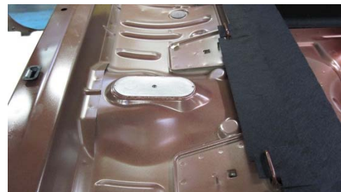
Kłapka bezpiecznika termicznego pod tylną kanapą
