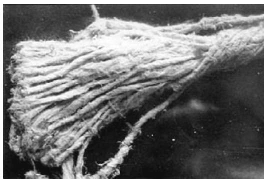
Zdjęcie 12 Sznur azbestowy stosowany w uszczelnieniach izolacji cieplnej
