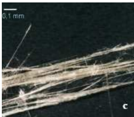
Zdjęcie 5 Długowłóknisty azbest chryzotylowy praktycznie nie zawierający talku (a), chryzotylowy azbest krótkowłóknisty zanieczyszczony talkiem (b) i azbest amozytowy (c)
