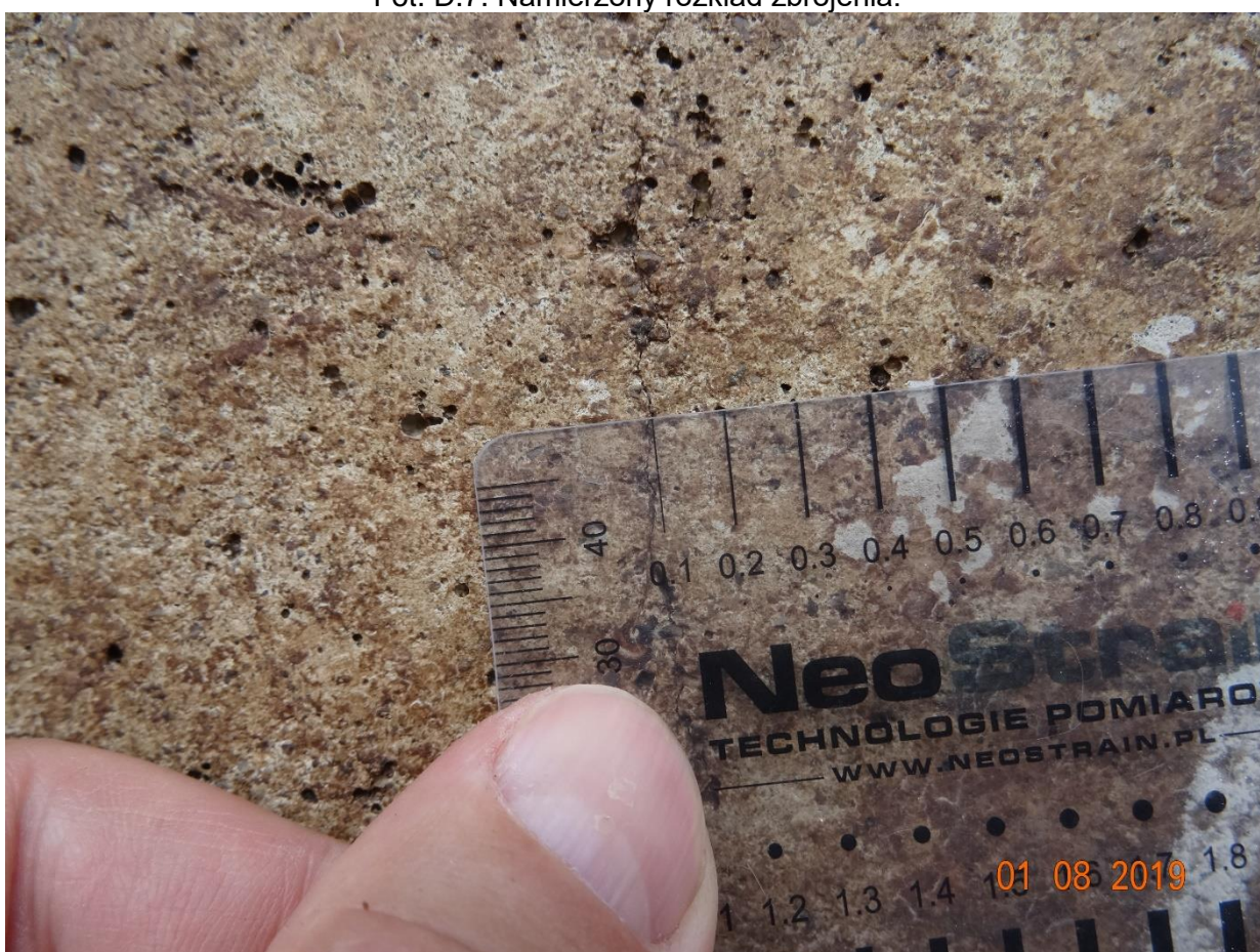
Fot. D.8. Pomiar szerokości rys ściany.
