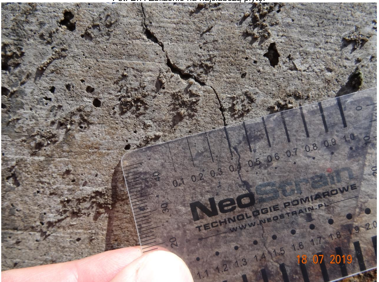
Fot. E.8. Rysa o szerokości 0,4 mm.
