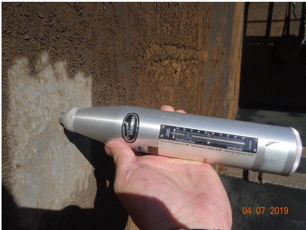
Fot. B.3. Badanie młotkiem Schmidta.
