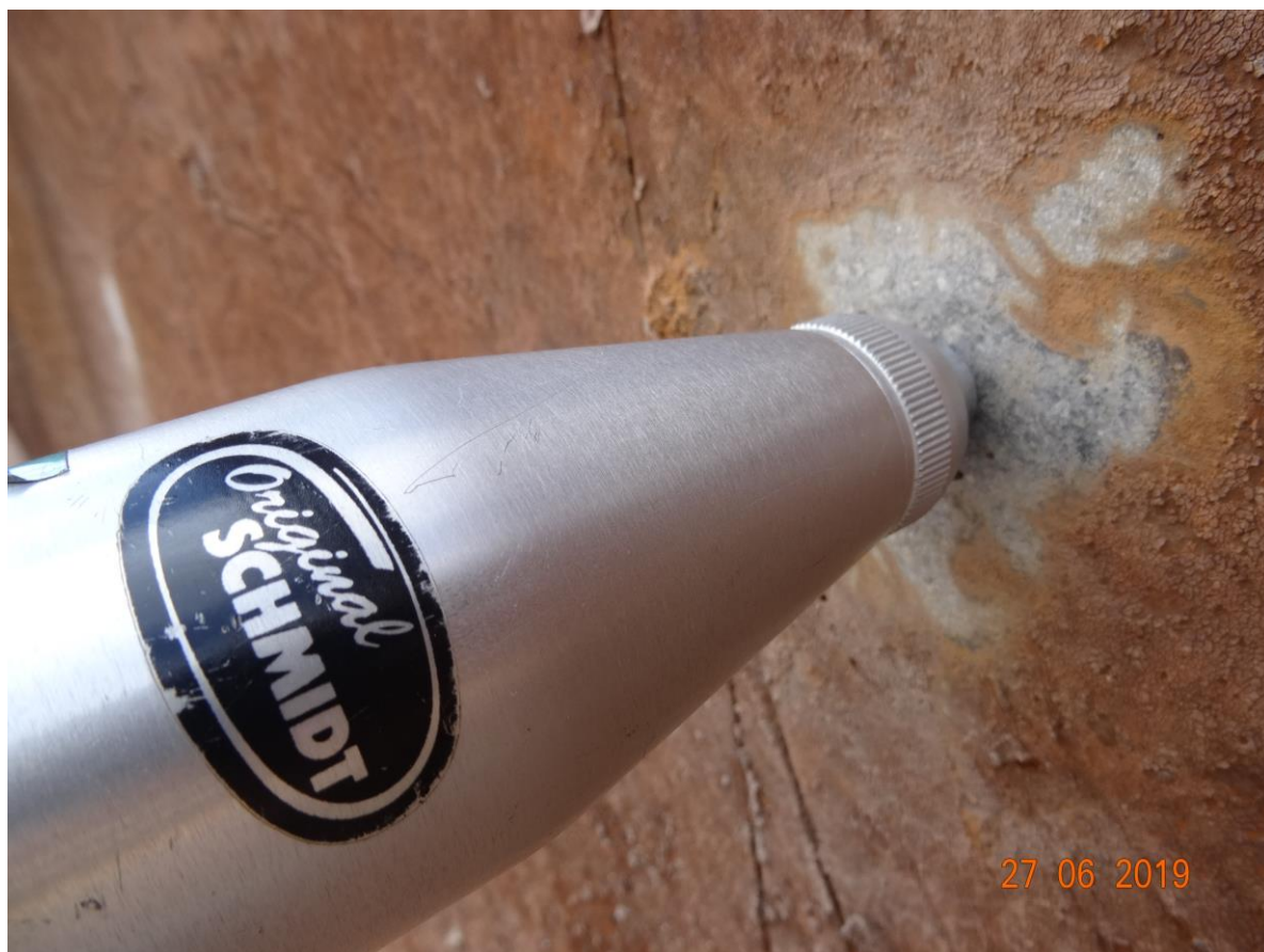
Fot. A.9. Badanie młotkiem Schmidta. Powierzchnia prefabrykatu.
