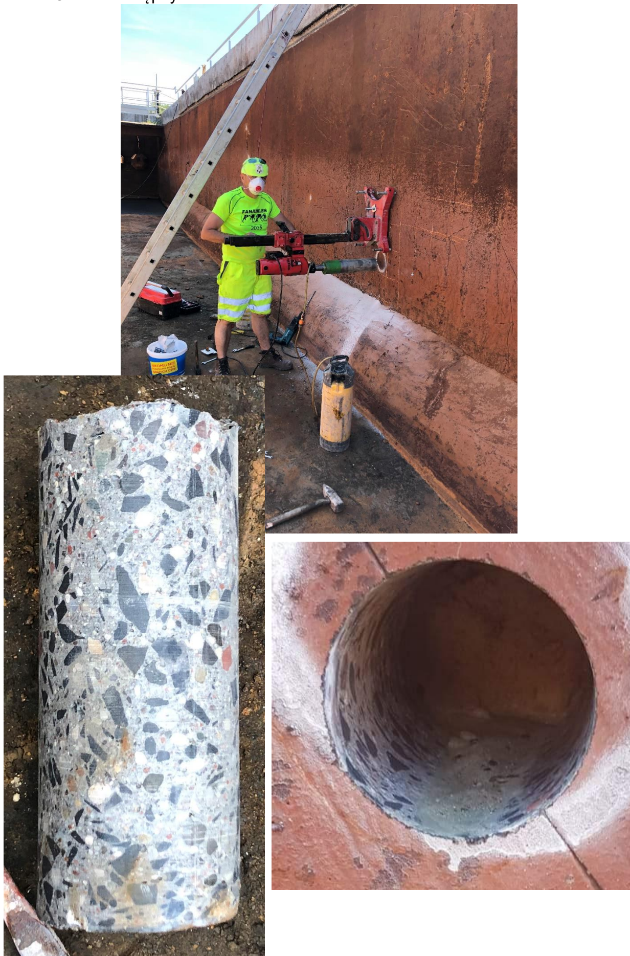
Fotografie. POBRANE PRÓBKI DO BADAŃ. A. Osadnik wstępny. Komora 1. Ściana.
