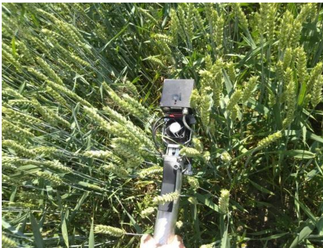
2.4Fot. 1.. Leaf Area Index (LAI Pomiar parametrów fotosyntezy w warunkach polowych) po wykłoszeniu.
