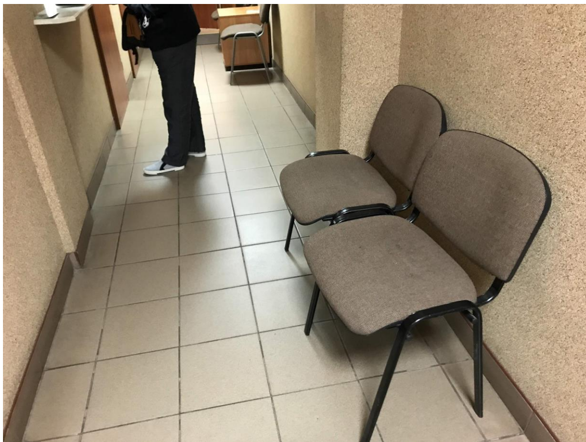
Fot. 8. Miejsca odpoczynku bez podłokietników, nie przytwierdzone i zawężające komunikację.
