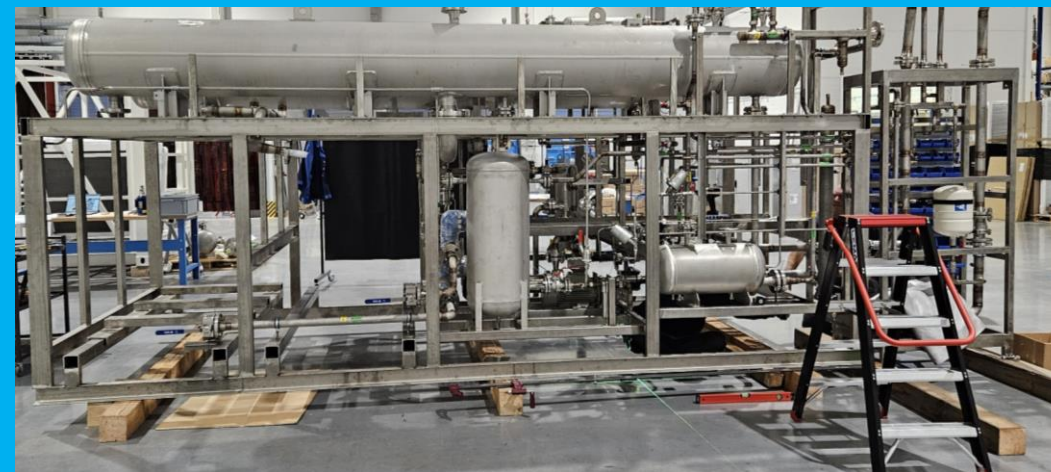
Fabryka autobusów | Elektrolizer alkaliczny 0,5 MW
