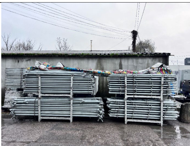
Fot. 1 – Widok stojaków i stężeń w koszach.
