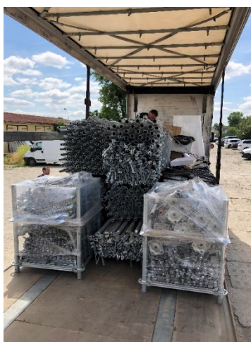
Fot. 2 Widok podstaw śrubowych, stojaków, stężeń i złącz rozetowych
