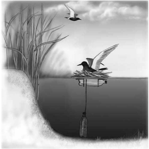
Pojedyncza platforma w przekroju i sposób kotwiczenia Rys. Joanna Lidke
